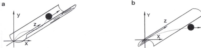
**Figure 1.45. : Analogie de la trajectoire d'un ion avec celle d'une bille dans une gouttière :**
