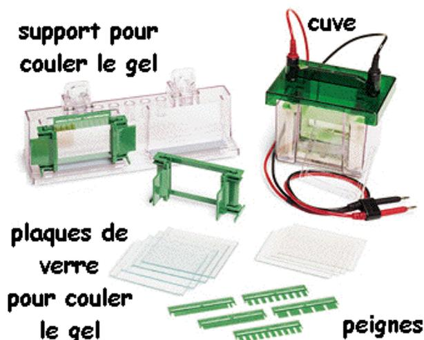
**Figure 2.20. : Matériel nécessaire pour couler un gel électrophorétique :**
